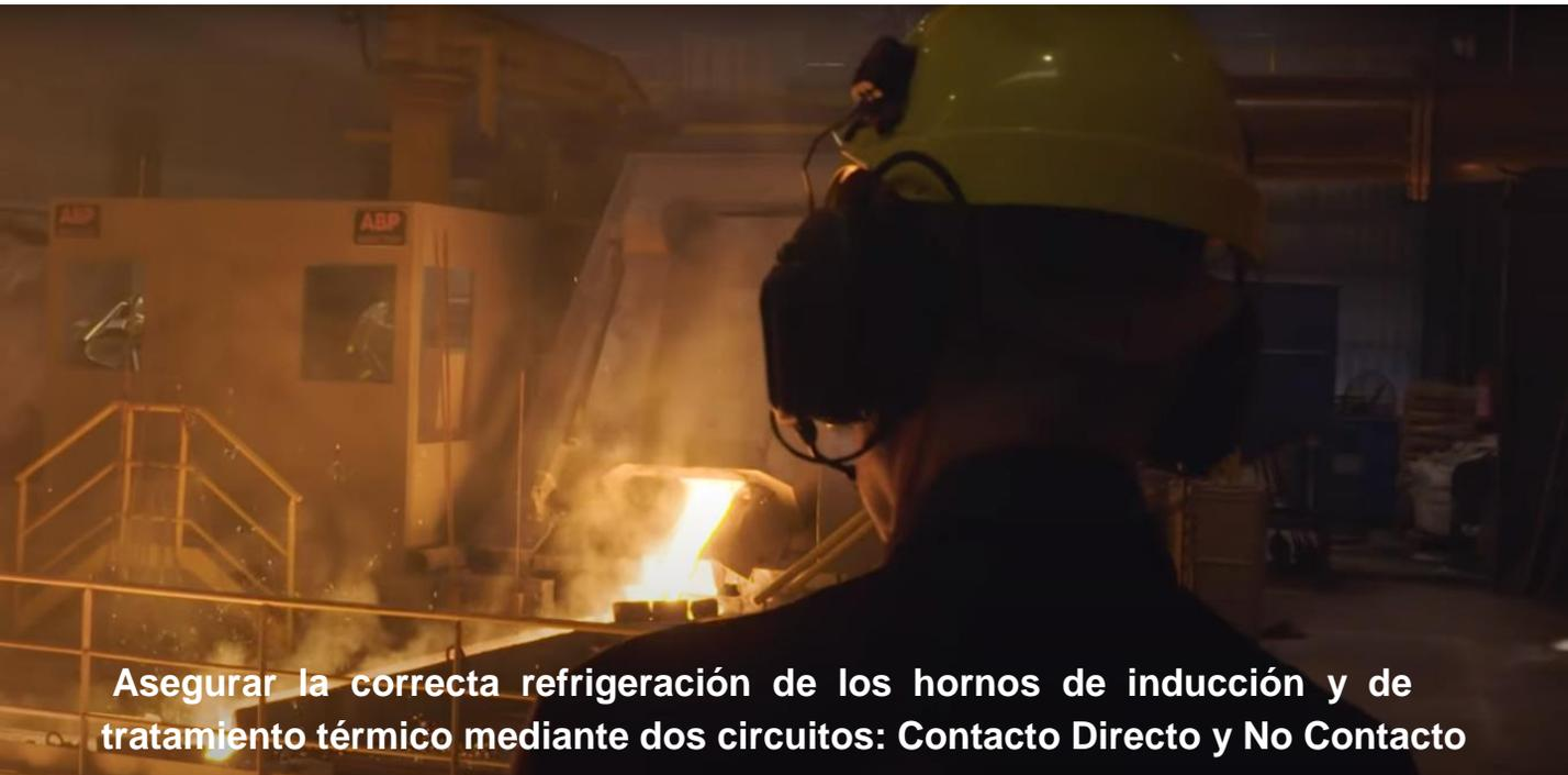
**Asegurar la correcta refrigeración de los hornos de inducción y de tratamiento térmico mediante dos circuitos: Contacto Directo y No Contacto**
