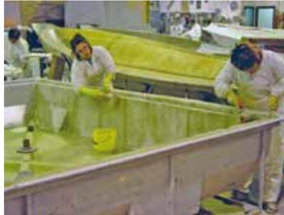
PRFV (material no corrosivo) proceso de fabricación
